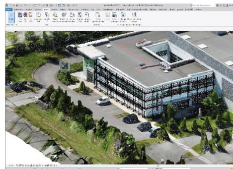
Le modèle 3D est transféré sous Sketchup, AutoCAD et Revit
