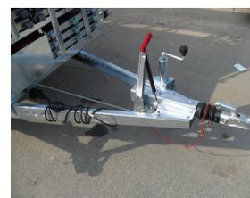
Deux systèmes d'accroche sont disponibles : par anneau ou par boule. La stabilité au parking est assurée par frein à main et béquille.
